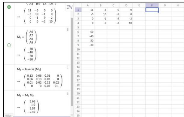
Figura 6. Resolución del SEL relativo a Figura 5 con GeoGebra
